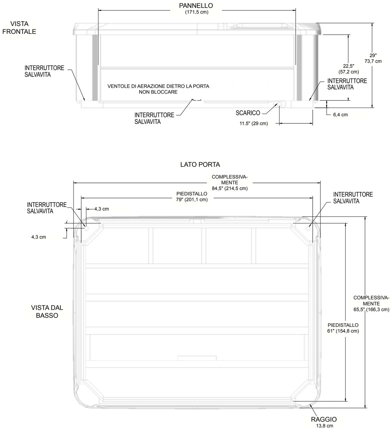
**NOTA:** WATKINS WELLNESS consiglia di installare il modello **STRIDE** su una base di cemento armato spessa 10 cm o una struttura solida in grado di sostenere il peso morto indicato nella tabella delle specifiche della vasca idromassaggio.
