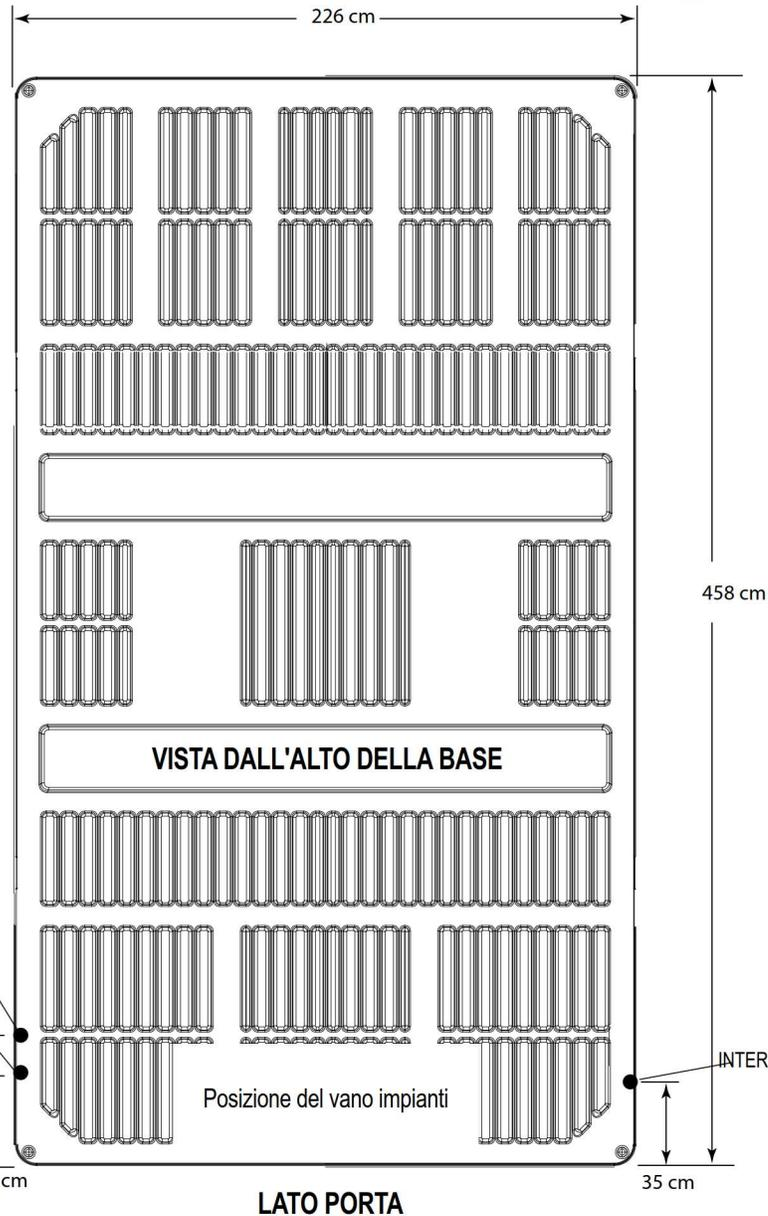
**NOTA:** ENDLESS POOLS richiede che l'installazione dei modelli E500 avvenga su una base di cemento armato spessa almeno 15 cm o una struttura solida in grado di sostenere il peso morto indicato nella tabella delle specifiche sull'ultima pagina.
