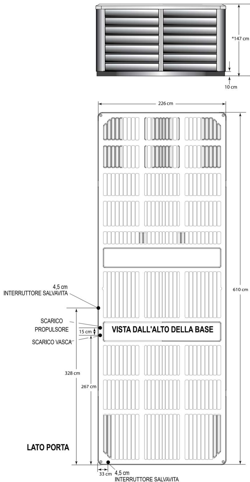
**NOTA:** SWIMCROSS consiglia di installare i modelli X2000 su una base di cemento armato spessa almeno 15 cm (6") o una struttura solida in grado di sostenere il peso morto indicato nella tabella delle specifiche sul retro della pagina.
